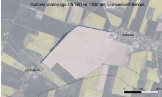
Budowa wodociągu DN 160 ok. 1300 mb Szymanów-Kulenów.
